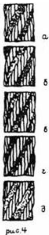
Рис. 4. Износ наружных проволок каната крестовой свивки:
